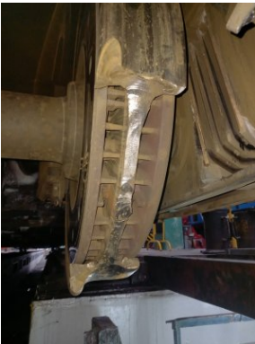
Pęknięcie koła w pojeździe SA136
