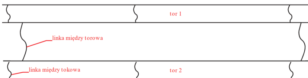
Rysunek 199. Sieć powrotna zwierana równoległe
