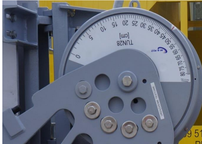
Zdjęcie 61. Widok podziałki urządzenia naprężającego typu TUN
