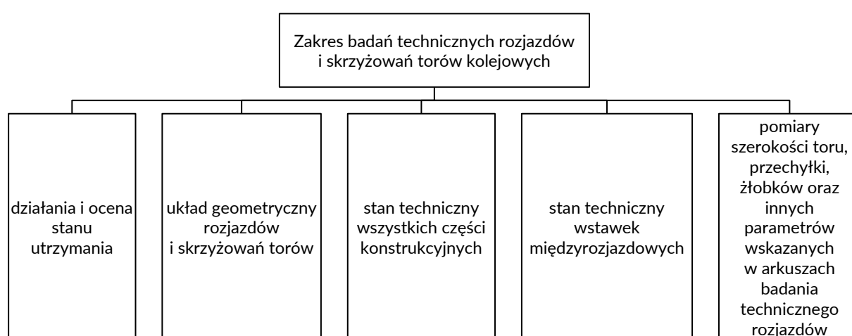
Rysunek 145. Zakres badań technicznych rozjazdów i skrzyżowań torów kolejowych
