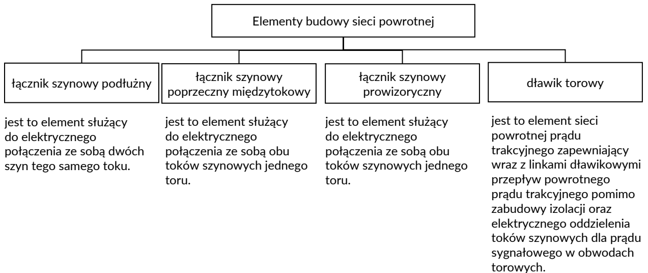
Rysunek 201. Elementy budowy sieci powrotnej
