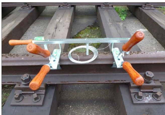
Zdjęcie 35. Zamontowany strzałkomierz w terenie
