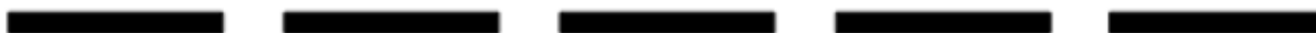
Rysunek 279. Sygnał A6 „Potwierdzenie otrzymania sygnału alarmu powietrznego przez pociąg na szlaku”
