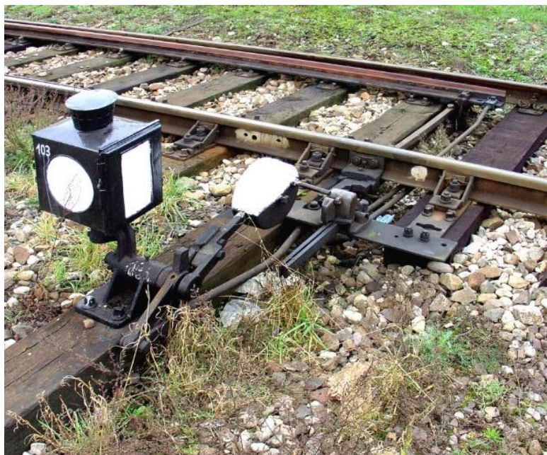
Zdjęcie 1. Napęd zwrotnicowy (wykolejnicowy) ręczny. Zwrotnik do przestawiania zwrotnicy
