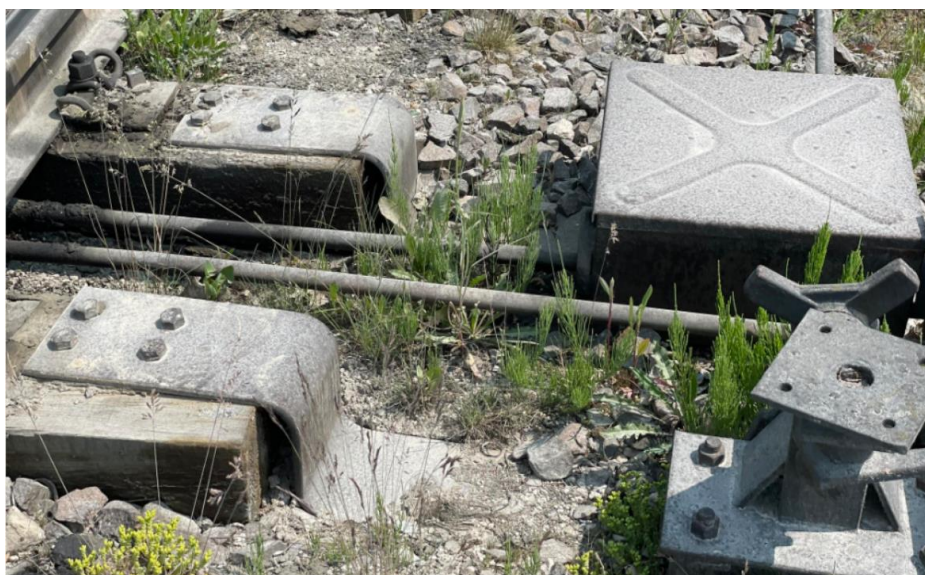
Zdjęcie 28. Mechaniczny napęd zwrotnicowy bez kontroli położenia
