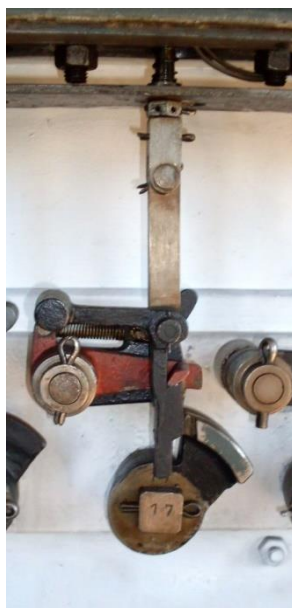
Zdjęcie 48. Kolejne fazy pracy zawórki przeciwwtórnej
