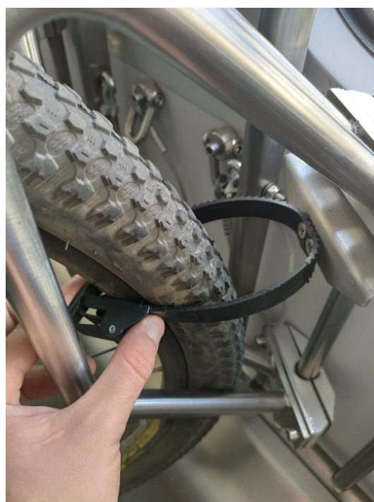
Rys. 2 Opaska stabilizująca dolne koło roweru zastosowana na wagonie typu 111A-30, fot. S. Kudelka
