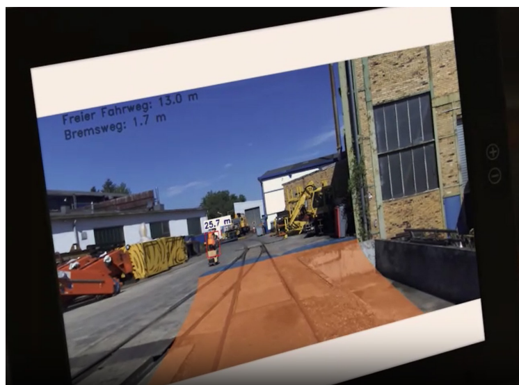
Rys. 20. Obraz w czasie rzeczywistym ze wskazaniem możliwych zagrożeń [13]
