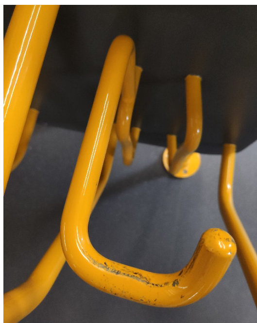
Rys. 8 Uszkodzony hak mocujący rower w pojeździe 31WEba, fot. S. Kudelka
