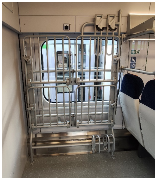
Rys. 2 Opaska stabilizująca dolne koło roweru zastosowana na wagonie typu 111A-30, fot. S. Kudelka
