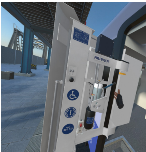
Rysunek 20. Podnoszenie windy z użyciem ręcznej pompy
