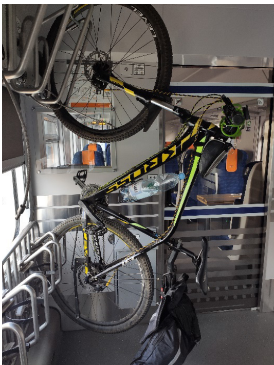
Rys. 1 Rower umiejscowiony pionowo w wagonie typu 111A-30 zmodernizowanym przez spółkę PESA Bydgoszcz SA, fot. S. Kudelka
