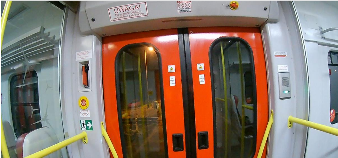
Zdjęcie 7 - Widok z wnętrza pojazdu na zainstalowany interkom przy drzwiach wejściowych (monitoring pojazdu).
