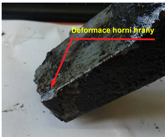
Obr. č. 16: Trvalá plastická deformace horní hrany zlomeného závěrového háku pravého vnitřního ohnutého jazyka Zdroj: DI
