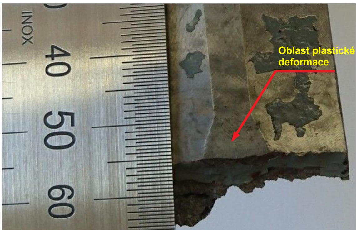
Obr. č. 14: Plastická deformace na konci zešikmení na horní stěně zlomeného závěrového háku pravého vnitřního ohnutého jazyka Zdroj: DI
