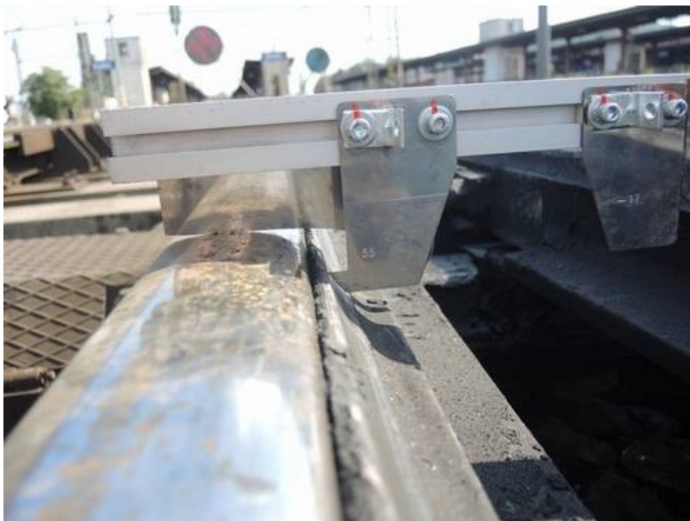
Obr. č. 10: Měření prostorovou šablonou PŠR-3 na výhybce č. 169a
