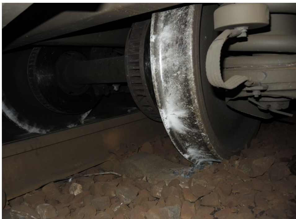
Obr. č. 9: Vykolejená kola dvojkolí u zadního podvozku TDV č. 61 54 20-70 031-7
