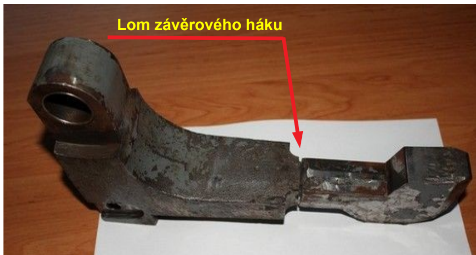
Obr. č. 18: Zlomený závěrový hák z čelistového výměnového závěru PHS výhybky č. 171ab Zdroj: DI
