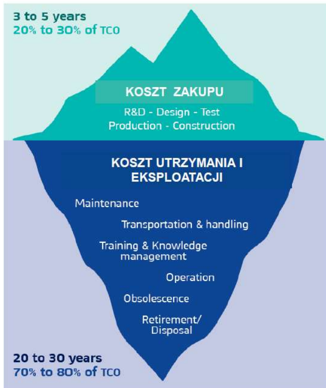
Rysunek 40. LCC pojazdu szynowego jako suma kosztów nabycia i kosztów posiadania.
