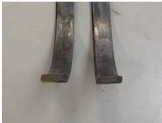
Zużycie pierścienia blokującego wokół narożników nośnych.
