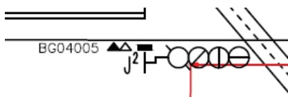
Rysunek 16 Rozmieszczenie balis przed semaforem wyjazdowym J stacji Płońska
