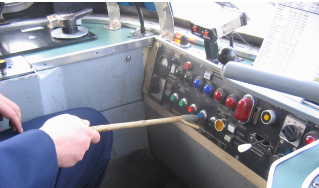
Rysunek 2 Pulpit sterowniczy zbyt oddalony od fotela – zamiast dostosowania maszyny do człowieka, to prowadzący dostosowuje się do maszyny, wykorzystując dodatkowe „pomoce” tak, by nie musieć pochylać tułowia w celu użycia przycisków, np. przy sterowaniu drzwiami na każdym przystanku. (fot. M. Górowski)
