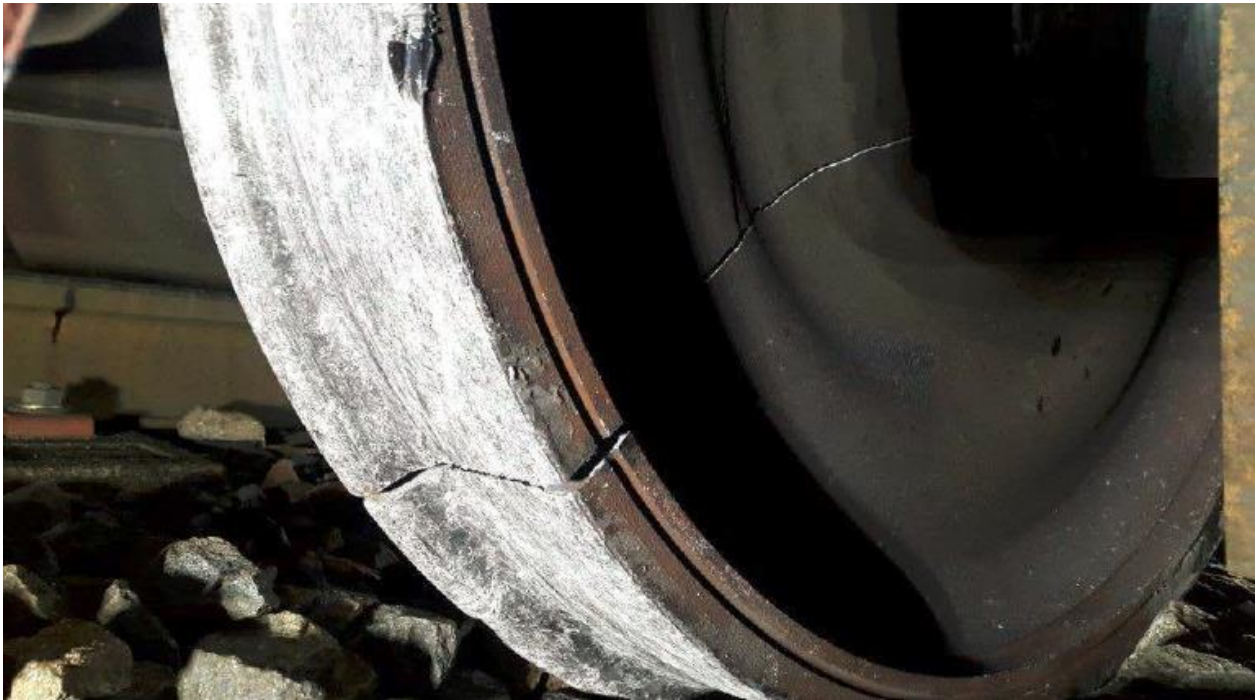
Pęknienie koła w kierunku promieniowym
