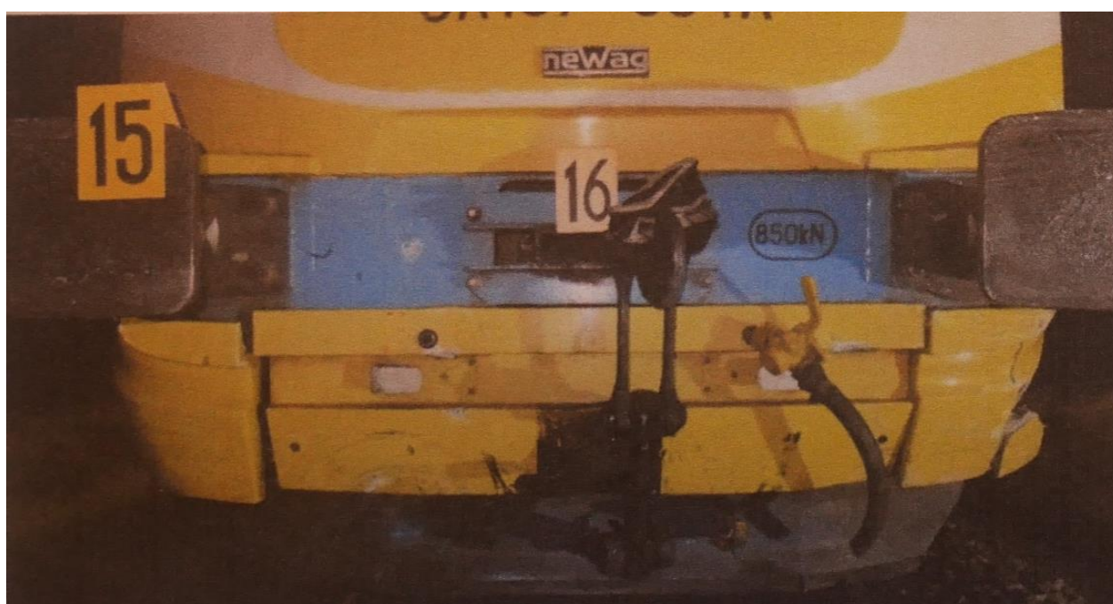
Fot. 12 i 13. Uszkodzenia szynobusu
