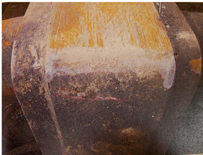
Fot.26. Ślady tarcia ramy naczepy o nawierzchnię jezdnii
