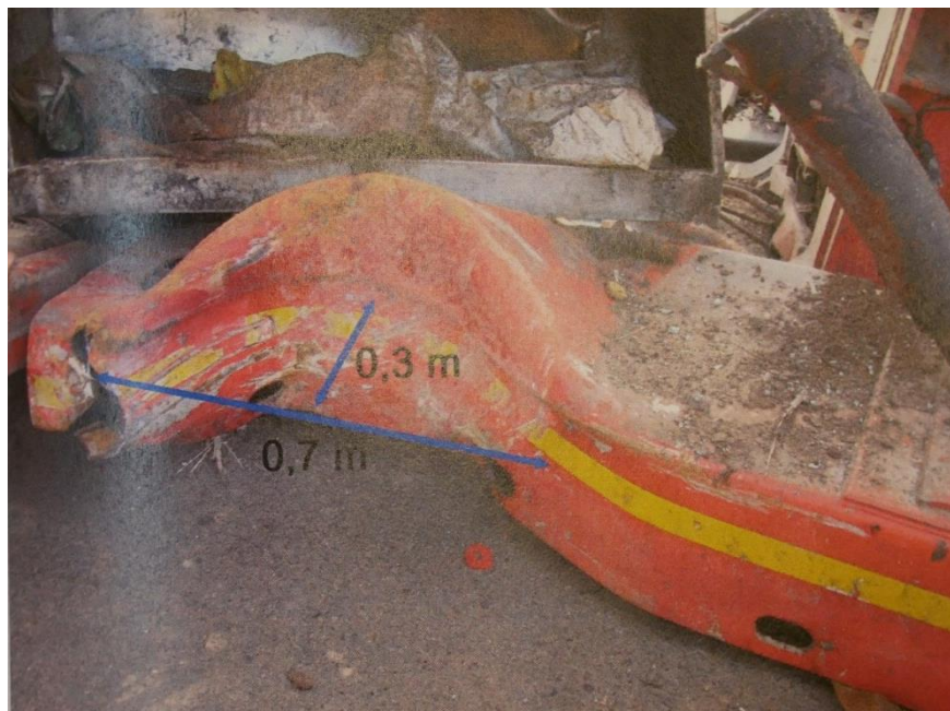
Fot.25. Uszkodzenia naczepy, ślady uderzenia od zestawów kołowych pociągu
